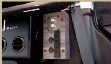
■天井照明スイッチ・電源システム
